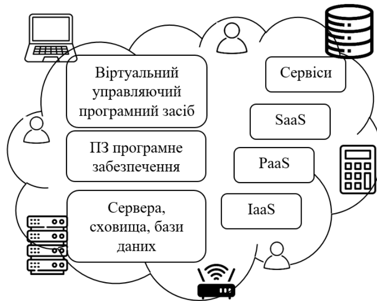
Рис. 4.4 Схема типової архітектури хмарних систем
